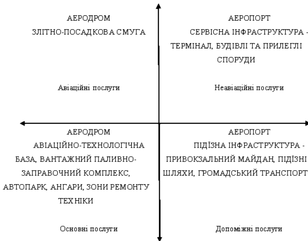
Рис. 1. Функціональна схема аеропорту
